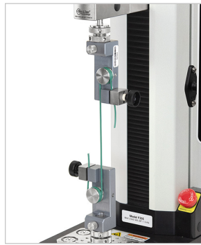
Wire tensile testing
